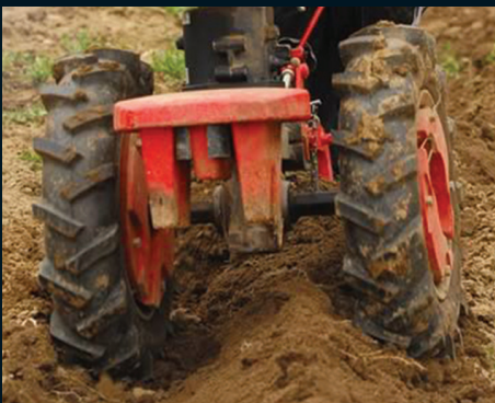
Figura 11: Exemplo de um pneu / roda com diâmetro maior em relação à largura. © Talltires
