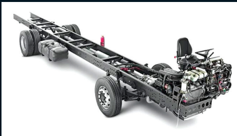
Figura 4: Exemplo de um chassi usado na plataforma dos ônibus urbanos. © Mercedes Benz
