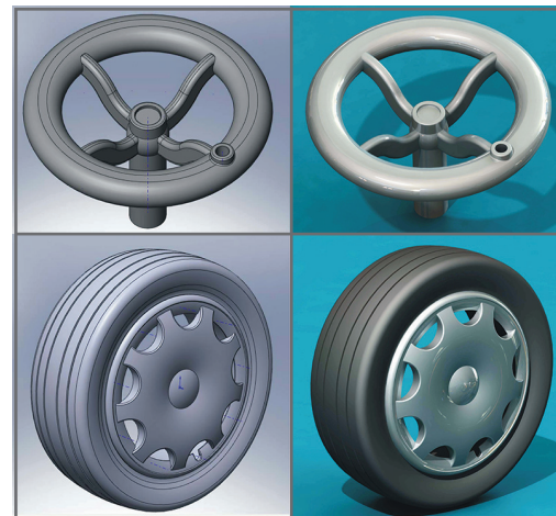
Figura 5: Vistas ilustrativas representando as diferenças de modelagem, empregando para ambos os objetos, os comandos Extrude, Cut-extrude e Revolve.
