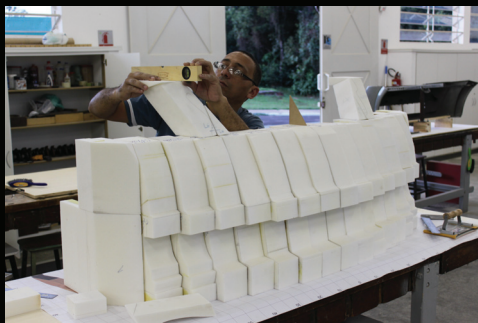
Figura 14 Fixação das colunas laterais da grade superior do modelo.
