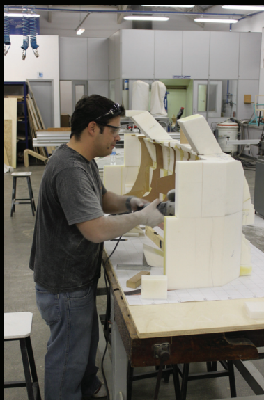
Figura 15 Eliminação de excessos de espuma PU na parte interna do modelo.
