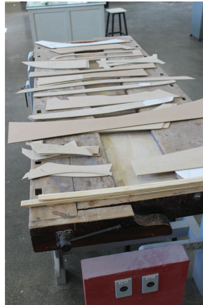
Figura 24 Chapelonas negativas usadas como apoio e conferência. © Henrique Altman de Souza Campos
