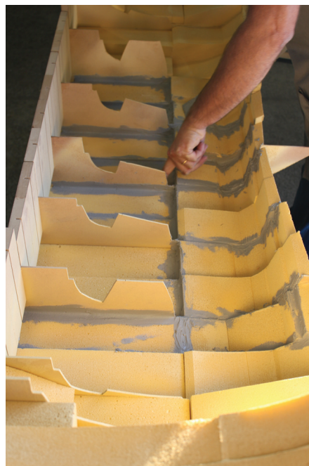
Figura 26 Parte interna do modelo reforçada com massa plástica. © Henrique Altman de Souza Campos
