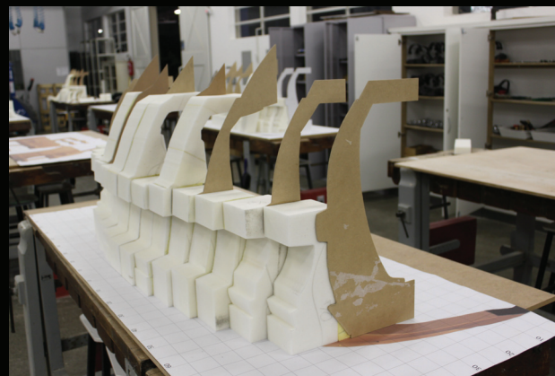
Figura 11 Preenchimento da parte superior do modelo com espuma rígida de PU. © Henrique Altman de Souza Campos
