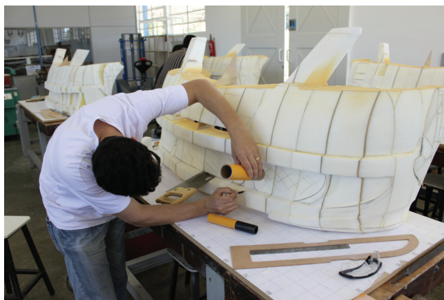
Figura 27 Determinação das áreas a serem removidas na parte inferior do modelo. © Henrique Altman de Souza Campos
