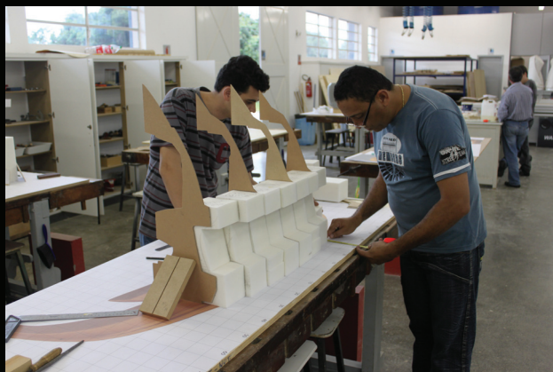
Figura 10 Preenchimento da parte inferior do modelo com espuma rígida de PU. © Henrique Altman de Souza Campos
