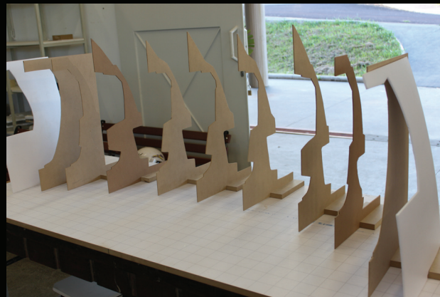
Figura 9 Sequencia das chapelonas positivas já posicionadas. © Henrique Altman de Souza Campos
