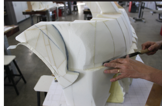
Figura 18 Modelagem (desbaste fino) da lateral direita do modelo.
