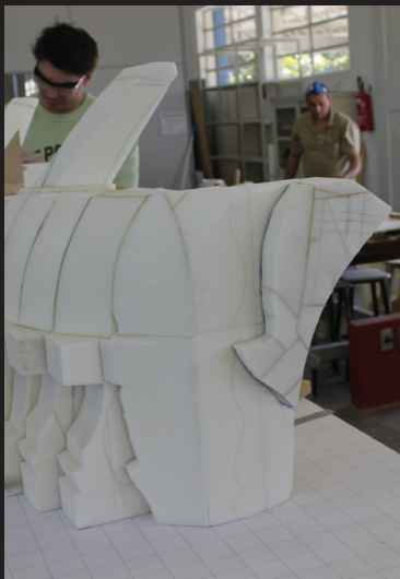
Figura 54 Lateral do modelo cuja escultura dependeu de chapelonas negativas.
