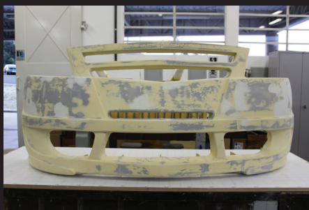
Figura 37 Nivelamento superficial (lixamento) após a segunda demão de primer. © Henrique Altman de Souza Campos
