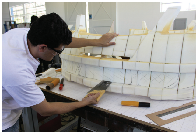
Figura 28 Corte das aberturas referentes as tomadas de ar inferiores do modelo. © Henrique Altman de Souza Campos
