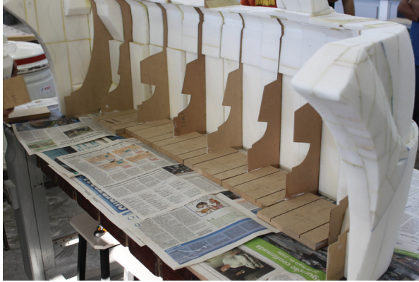
Figura 21 Bases das chapelonas positivas se transformaram na própria base do modelo. © Henrique Altman de Souza Campos
