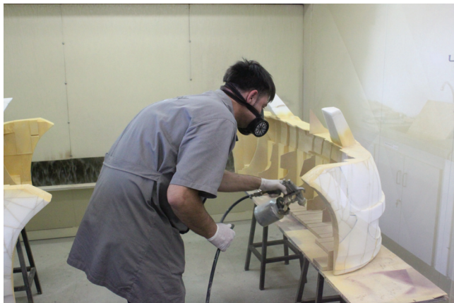
Figura 25 Aplicação do primer PU na parte interna do modelo. © Henrique Altman de Souza Campos
