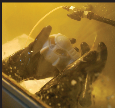
Figura 11 Detalhe da remoção dos suportes por jateamento d'água.
