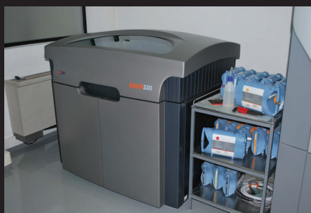
Figura 12 Instalações do CENTIMFE/Marinha Grande/Portugal, com a tecnologia Polyjet Objet/Eden 330.
