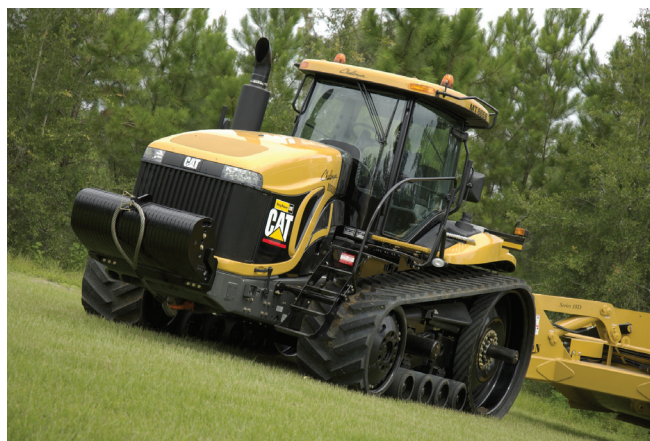
Figura 15 Trator equipado com esteiras de borracha. Fonte: Ring Power.
