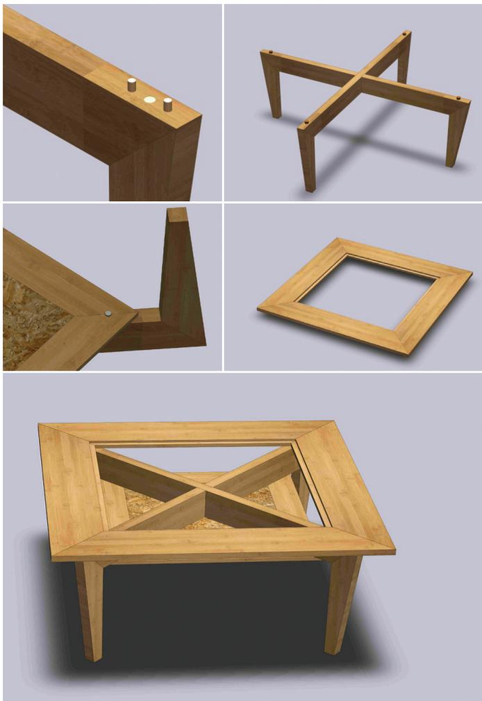
**Figura 7** Representações virtuais da mesa JAPONMESA com os detalhes de encaixe, componentes e modelagem final do produto.
