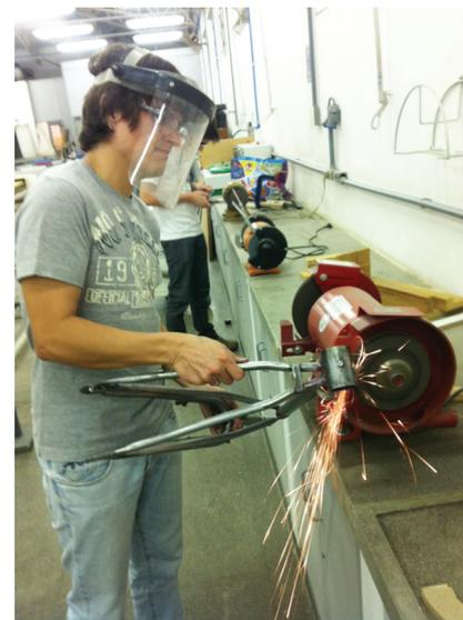
**Figura 12** Remoção de camada de tinta com escova no moto esmeril (a), uso do moto esmeril para remoção da tinta velha em superfícies irregulares (b).
