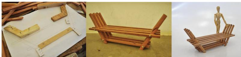
7. Revisão de projeto (do modelo em escala reduzida para o protótipo em escala real)
