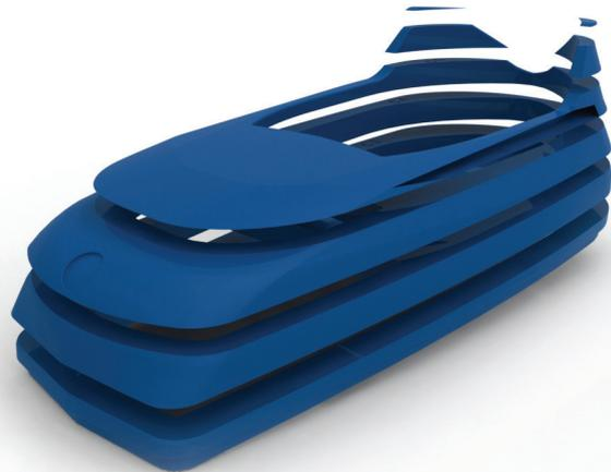
**Figura 07: Parte superior fatiada horizontalmente para a usinagem.**
