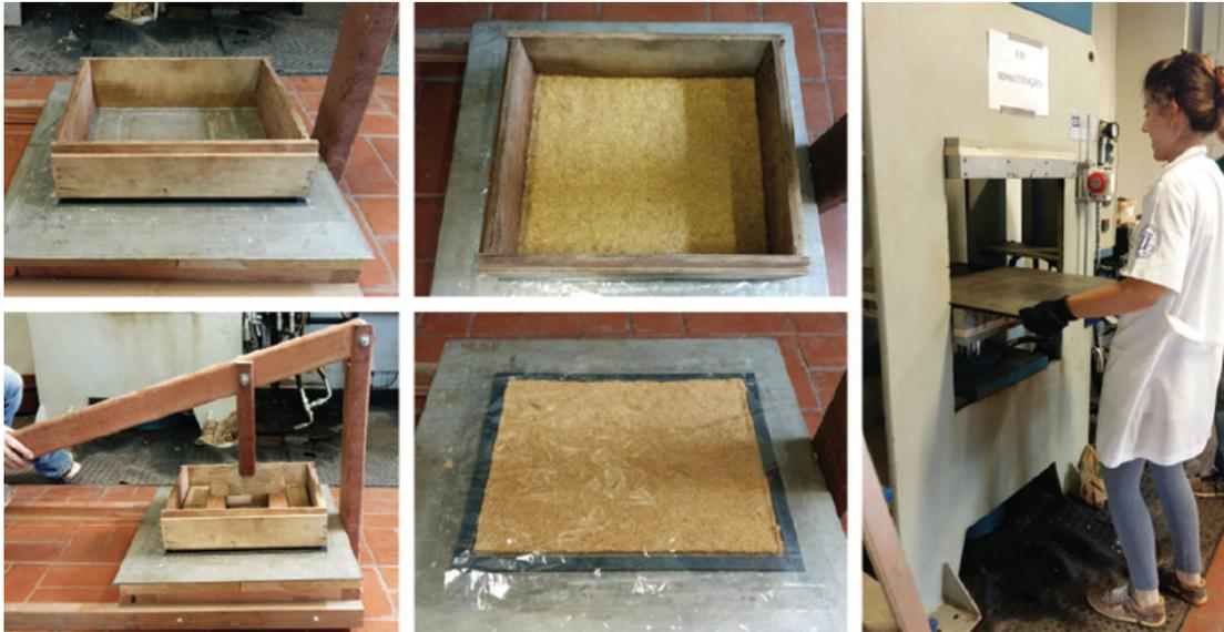
As condições de prensagem (temperatura, pressão e tempo de prensagem) a que foi submetido o colchão define as propriedades finais da chapa de aglomerado, portanto, são de fundamental importância. No ciclo de prensagem, ocorre a consolidação do material (VALARELLI, 2009). As chapas secas foram esquadrejadas em uma serra de fita retirando uma faixa de 2cm de cada lado visando obter a área adequada para o produto (Figuras 39 e 40).
