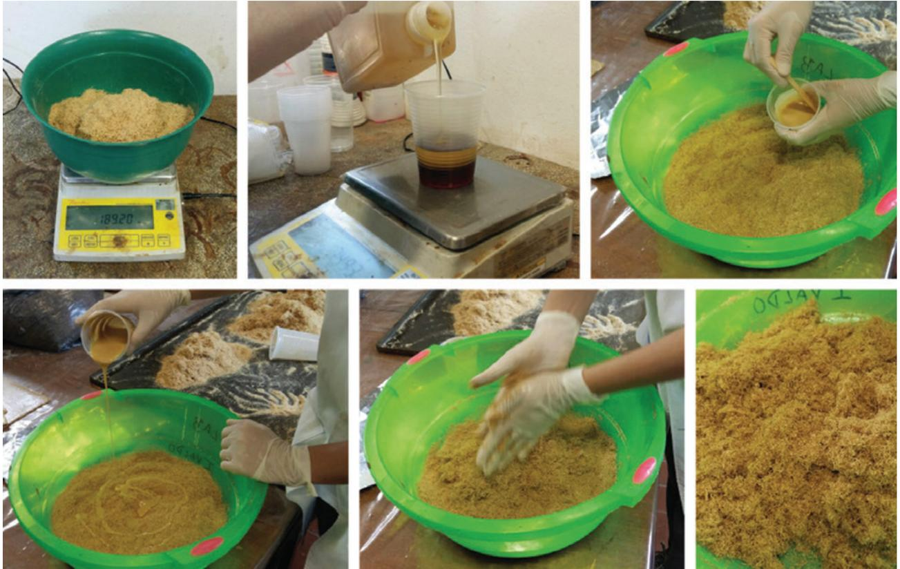
Figuras 28, 29, 30, 31, 32 e 33: Processo de produção das chapas de aglomerado de bambu finais.
