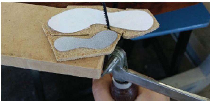
Figuras 44, 45, 46, 47 e 48: Processo de posicionamento dos moldes e recorte das chapas de aglomerado de bambu. Fonte: autora, 2017.
