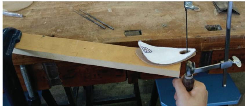
Figura 41: Teste do método produtivo e da forma do produto ao confeccionar um modelo escala 1:1. Fonte: autora, 2017.
