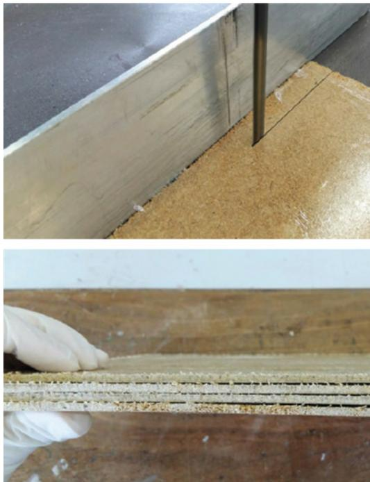
Figuras 39 e 40: Chapas de aglomerado sendo esquadrejadas após 72 horas de cura (detalhe das laterais). Fonte: autora, 2017.
