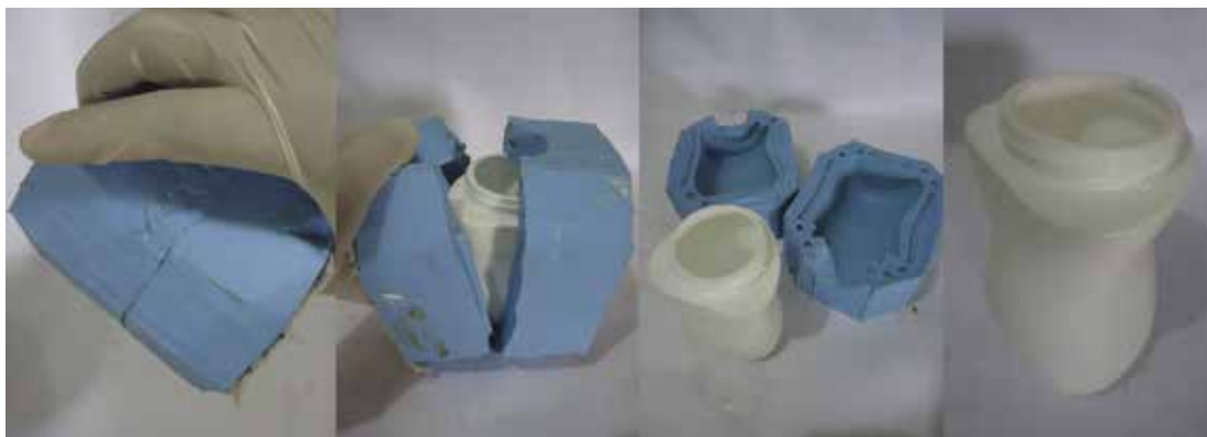
Figura 17: Modelo replicados em molde de silicone, através do processo de rotomoldagem, material Resina poliuretano. Fonte: os Autores
