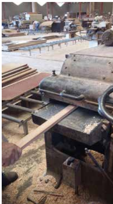
Figura 25- Processo de desengrosso Fonte: o Autor
