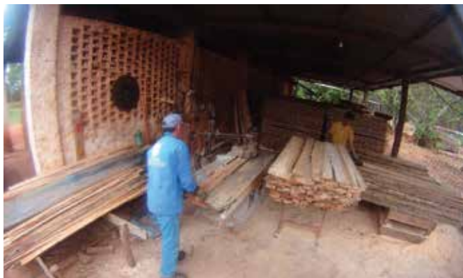
Figura 18- Serra circular refiladeira com avanço Fonte: o Autor
