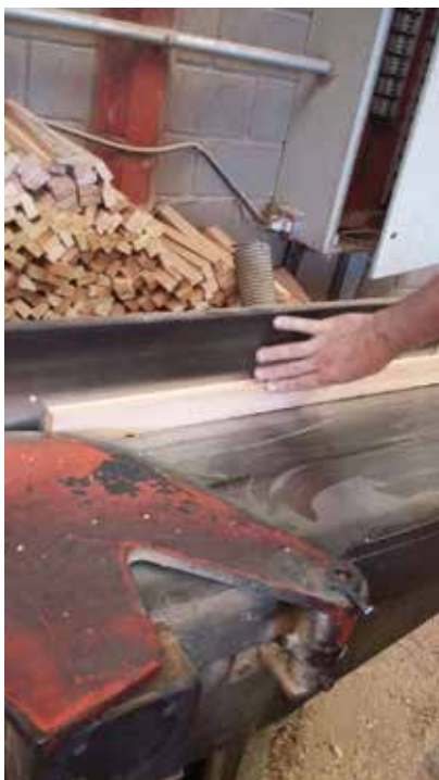
Figura 24- Processo de desempeno Fonte: o Autor
