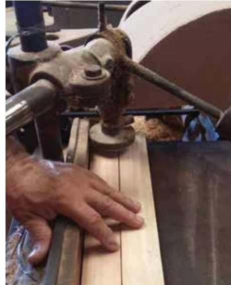
Figura 27- Processamento das espigas em respigadeira. Fonte: o Autor
