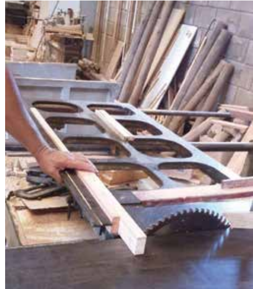
Figura 23- Seccionamento das pernas e travessas. Fonte: o Autor
