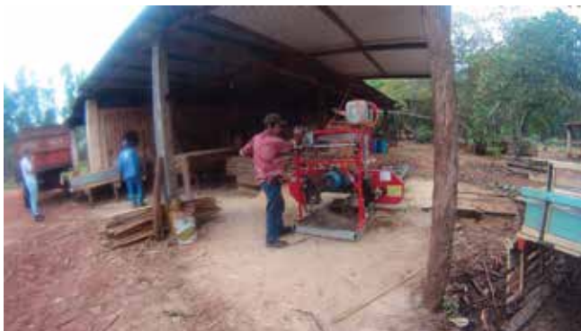
Figura 18- Serra circular refiladeira com avanço Fonte: o Autor
