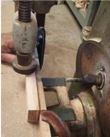
Figura 26- Execução das caixas para espiga em furadeira horizontal oscilante. Fonte: o Autor
