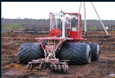
Figura 12: Exemplo de pneus / rodas com diâmetro menor em relação à largura. © Rolligon tyres
