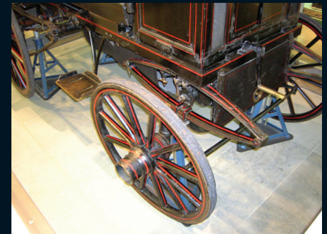
Figura 5: Carruagem equipada com suspensão com feixe de molas .
