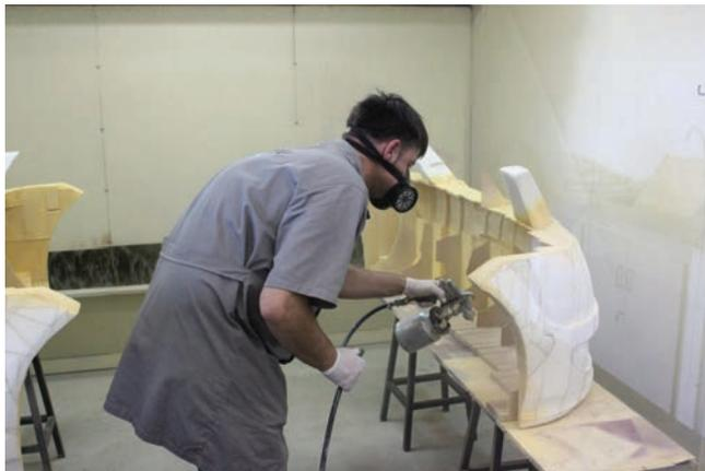
**Figura 25** Aplicação do primer PU na parte interna do modelo.
