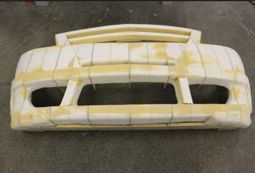
**Figura 32** Correção superficial por lixamento após a primeira demão de primer.
