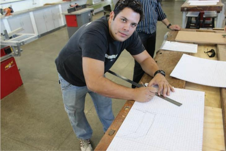
**Figura 51** Transferência dos pontos para a placa quadriculada da chapelona positiva.
