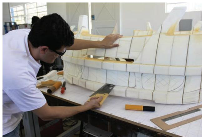
**Figura 28** Corte das aberturas referentes as tomadas de ar inferiores do modelo.
