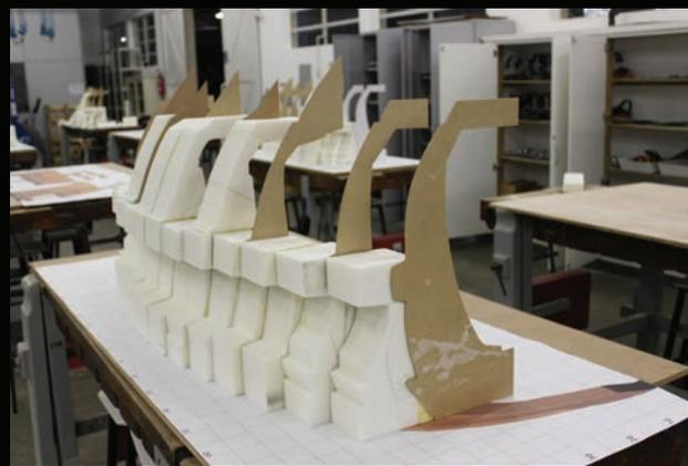
**Figura 11** Preenchimento da parte superior do modelo com espuma rígida de PU.
