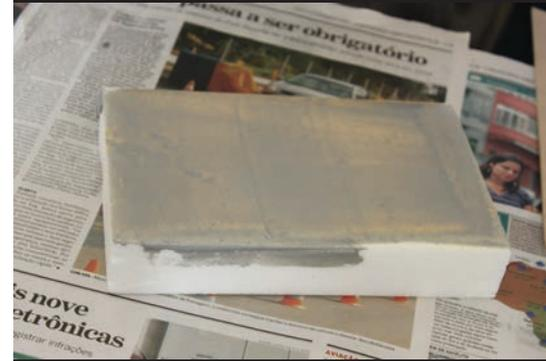
**Figura 35** Células da espuma fechadas com massa plástica.
