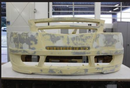
**Figura 37** Nivelamento superficial (lixamento) após a segunda demão de primer.
