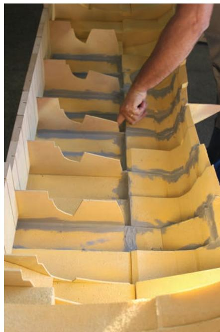
**Figura 26** Parte interna do modelo reforçada com massa plástica.
