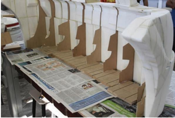
**Figura 21** Bases das chapelonas positivas se transformaram na própria base do modelo.
