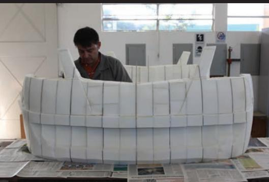
**Figura 20** Parte inferior do modelo no início de seu desbaste grosseiro.
