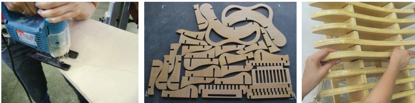
**Figura 7** Processo de produção dos componentes e etapas de montagem das peças.
