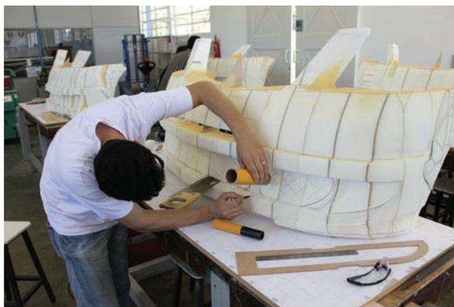
**Figura 27** Determinação das áreas a serem removidas na parte inferior do modelo.
