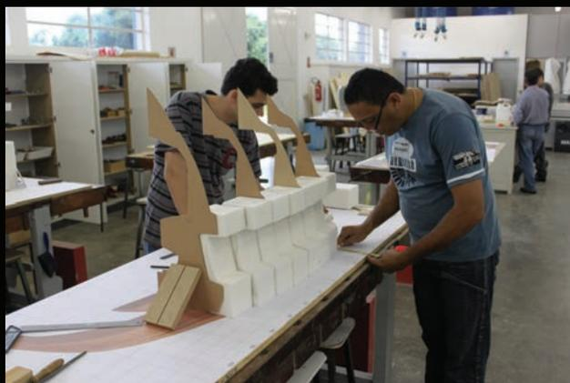
**Figura 10** Preenchimento da parte inferior do modelo com espuma rígida de PU.
