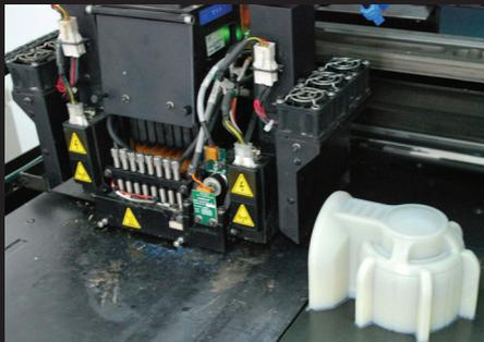
**Figura 10** Detalhe da cabeça de impressão da Polyjet.
