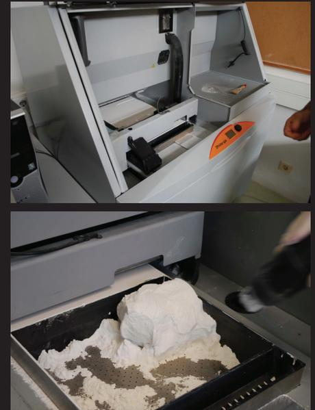
**Figura 18** Instalações do Laboratório de Prototipagem da ESAD/IPL/Caldas da Rainha/Portugal, com a Tecnologia 3D Printer ZCorp 450.
