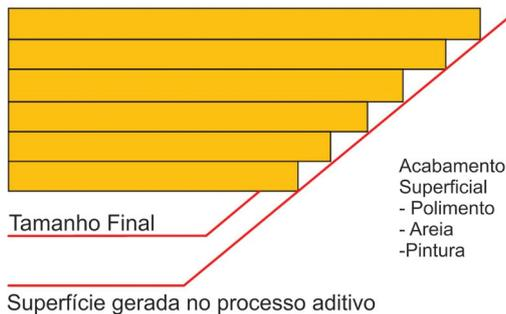
**Figura 8** Efeito escada é eliminado/reduzido manualmente através da utilização de técnicas de acabamento superficial.
