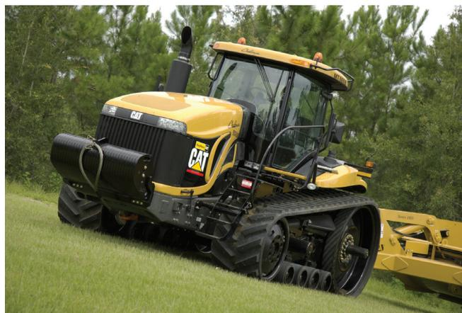
**Figura 15** Trator equipado com esteiras de borracha.
