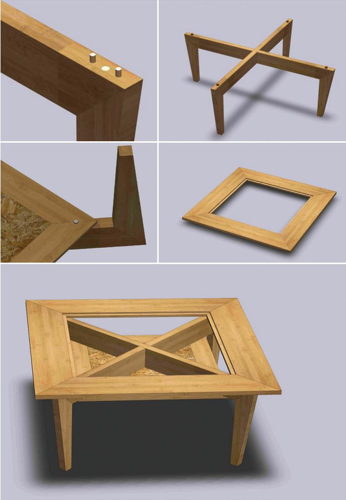
**Figura 7** Representações virtuais da mesa JAPONMESA com os detalhes de encaixe, componentes e modelagem final do produto.
