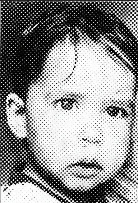
**Figura 23** Resultado impresso de imagem reticulada (meio-tom) usando-se o processo Offset (fonte: Ribeiro, 1997)
