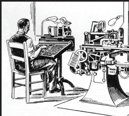
**Figura 20** Máquina de composição mecânica Monotype em operação (fonte: Ribeiro, 1987)
