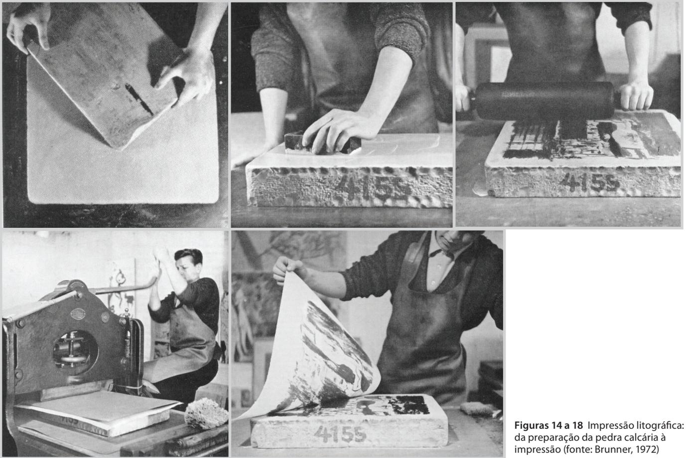
Figuras 14 a 18 Impressão litográfica: da preparação da pedra calcária à impressão (fonte: Brunner, 1972)
