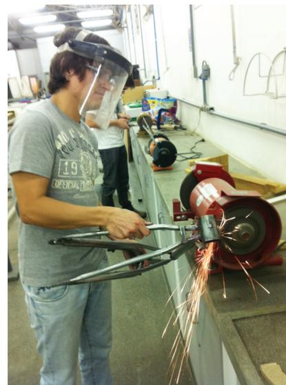
**Figura 12** Remoção de camada de tinta com escova no moto esmeril (a), uso do moto esmeril para remoção da tinta em superfícies irregulares (b).
