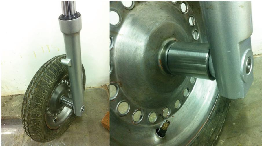
Figura 9 Montagem da roda dianteira, eixo e bengala.
