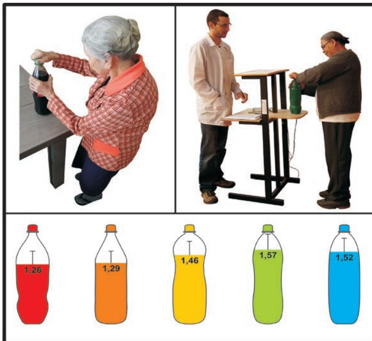
Figura 2 : Diagrama apresentando a problemática do acesso de idosos às embalagens PET de refrigerantes; os procedimentos metodológicos adotados para coleta de dados e os resultados médios da capacidade de transmissão de força máxima (em N.m), em cinco diferentes embalagens PET de refrigerantes.
