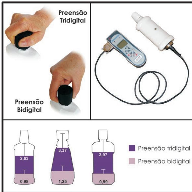
Figura 4: Diagrama apresentando a problemática quanto a forma de preensão em embalagens de enxaguantes bucais; os procedimentos metodológicos adotados para coleta de dados e os resultados médios da capacidade de transmissão de força máxima (em N.m), nos dois tipos de preensão e três diferentes embalagens.
