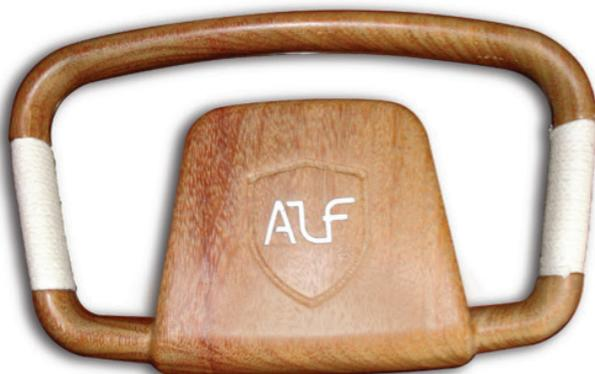
Figura 22: Volante finalizado com revestimento e emblema.
