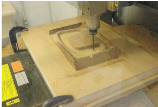
Figura 16: Usinagem do volante a partir de um bloco de madeira maciça.
