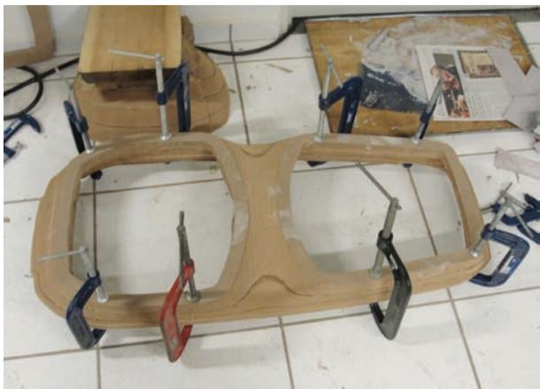
Figura 12: Peças usinadas em processo de colagem.
