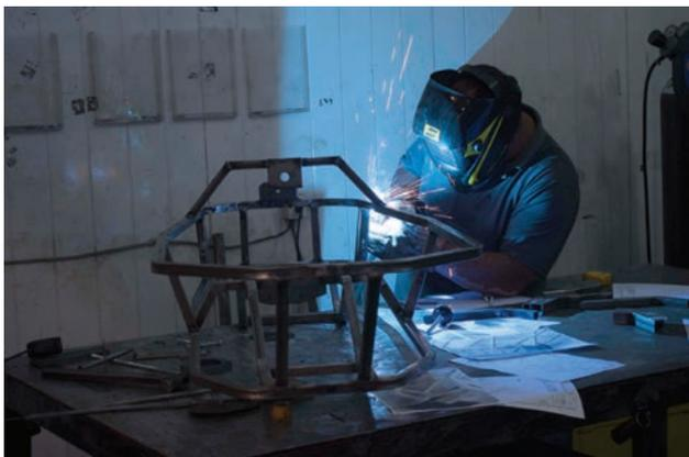
Figura 09: Estrutura em processo de soldagem.
