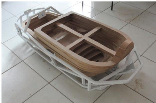
Figura 10: Teste de encaixe dos moldes na estrutura.
