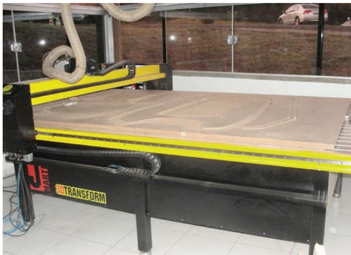
Figura 11: Chapa de MDF sendo usinada na router CNC.
