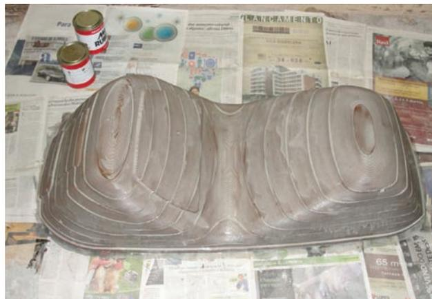
Figura 13: Molde colado e resinado externamente para o acabamento.
