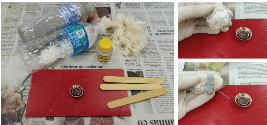
Figuras 67, 68 e 69: Processo e produtos empregados no polimento e na envernização das peças de cobre. Fonte: autora, 2017.
