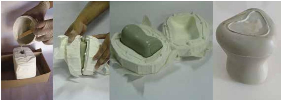
Figura 12: Modelo confeccionada em Resina Poliéster. Fonte: os Autores
