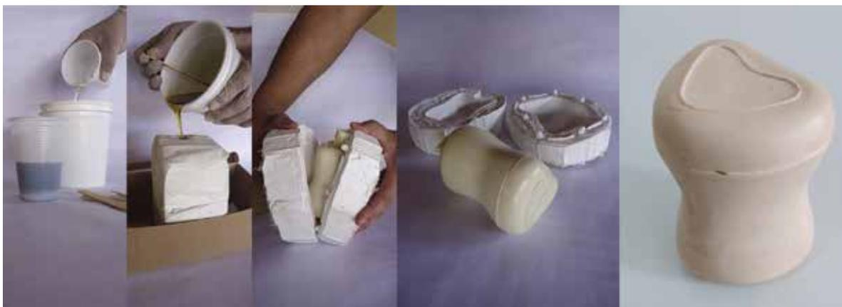
Figura 14: Modelo confeccionada em Resina PU. Fonte: os Autores
