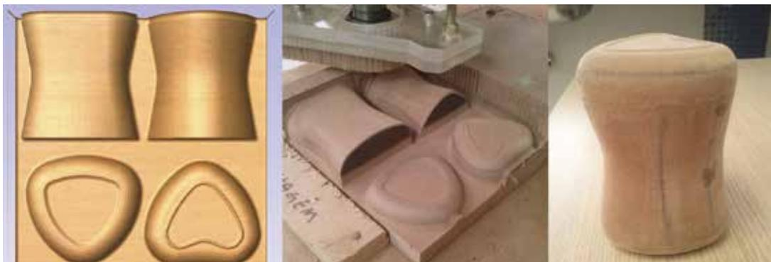
MDF na fresadora Router (técnica de manufatura subtrativa) em três partes que foram posteriormente unidas e receberam acabamento (Figura 10).
